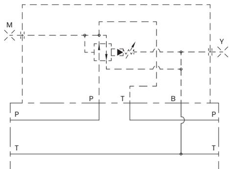
Base componibile in versione a tre tiranti per il montaggio della valvola riduttrice di pressione a piastra con interfaccia CETOP 3.
