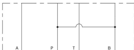
Elemento modulare di collegamento P in B CETOP 5
