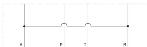
Elemento modulare con attacchi fil. da 3/8" BSPP.
